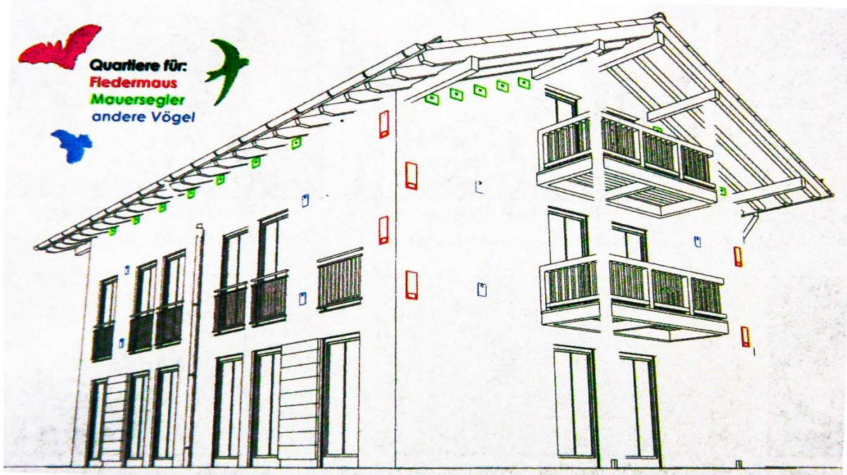
Einbaumöglichkeiten für unterschiedliche Quartiersteine an einem Doppelhaus
